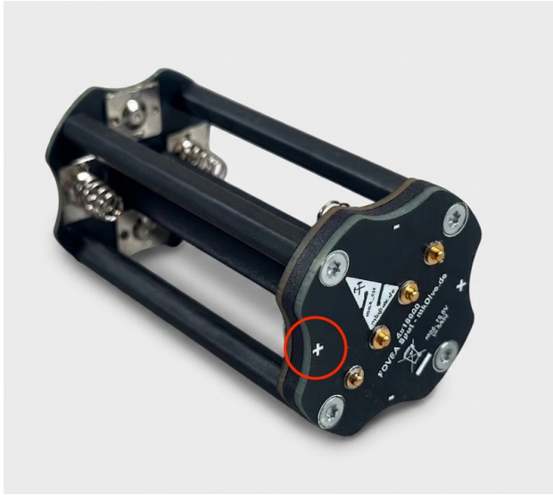
Abbildung 5: Einlegerichtung der Zellen im Batteriekäfig
